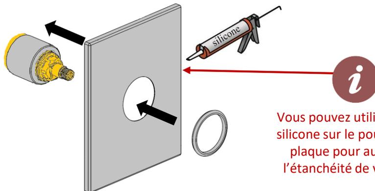
Vous pouvez utiliser un joint silicone sur le pourtour de la plaque pour augmenter l'étanchéité de votre mur.
